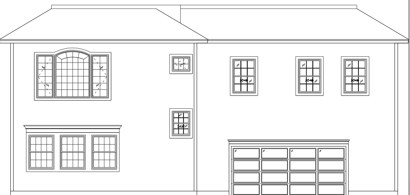
Right Elevation Scale: 1/8" = 1'0"
